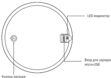
Кнопка на нижней поверхности включает и выключает питание светильника.
