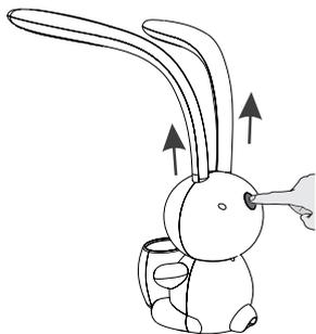
2.3 ВНИМАНИЕ: установка и снятие плафонов должны производиться при отключенном питании (выдернуть шнур из розетки!)
