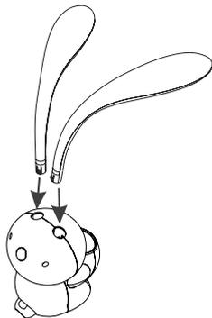
2.2. Если нужно снять плафоны, то нажмите на кнопку на задней поверхности «головы» и потяните плафон вверх
